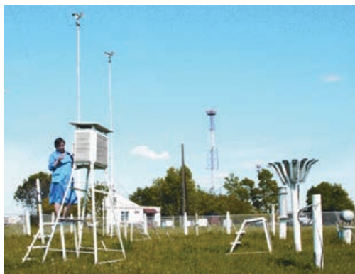
Рис. 54. Будка для термометра
