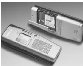
Dictafon digital Secvențele sonore în formă numerică se înmagazinează în cartela de memorie
