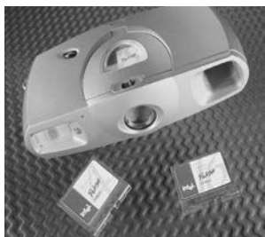
Aparat digital de fotografiat Imaginea numerică se înmagazinează în cartela de memorie
