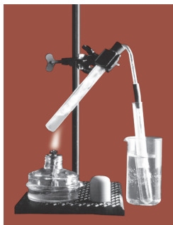
Рис. 4.6. Дистилляция (перегонка) воды в простейшем приборе
