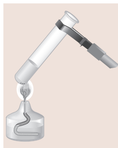
Рис. 1.21. Нагревание жидких веществ
