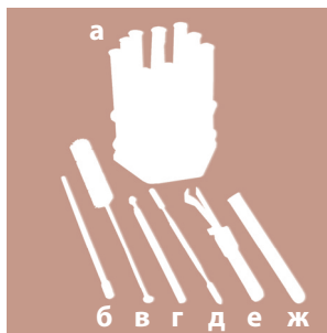
Рис. 1.15. Штатив для пробирок: а — пробирки; б — стеклянная палочка; в — щетка (ёршик); г — ложечка; д — шпатель; е — держатель для пробирок; ж — эталон объема.
