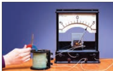
1.5. Получение электрического тока с помощью магнита
