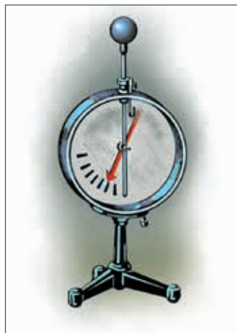
4.10. Электроскоп со стрелкой и шкалой (электрометр)
