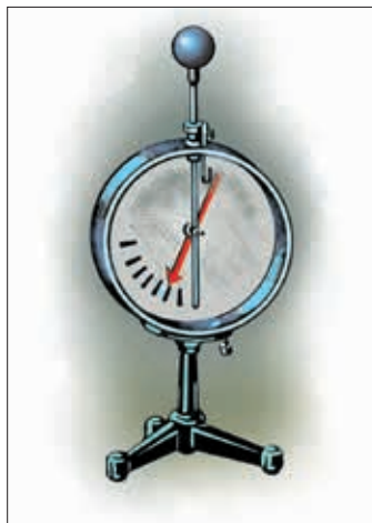
4.10. Electroscopul cu ac și cu cadran (electrometrul)
