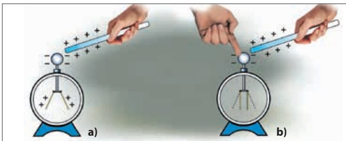
4.18. a) Încărcarea electroscofului prin influență; b) legarea cu Pământul
